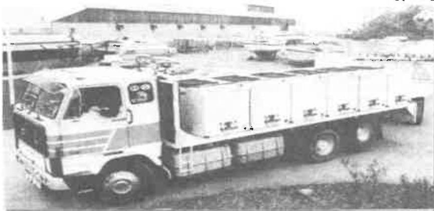
شکل ۱۳: تریلر حامل مخازن حمل ماهی زنده.
